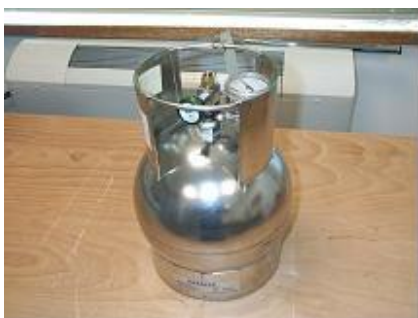
Prélèvement de COV par Canister
