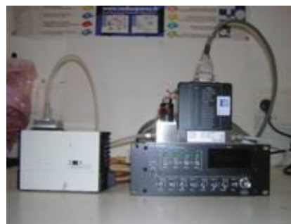
Prélèvement d'aldéhydes par cartouches DNPH
