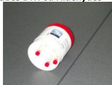
Matériel utilisé pour les Tubes NO 2
