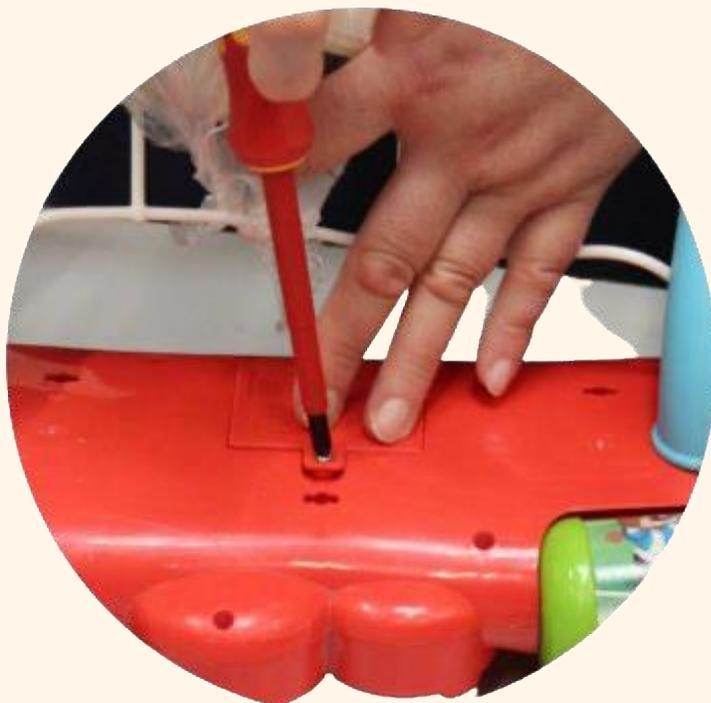
Le jouet ne doit pas présenter d'échardes, de traces de rouille de fissures ou de fentes, nous vérifions la solidité des collages, etc.
